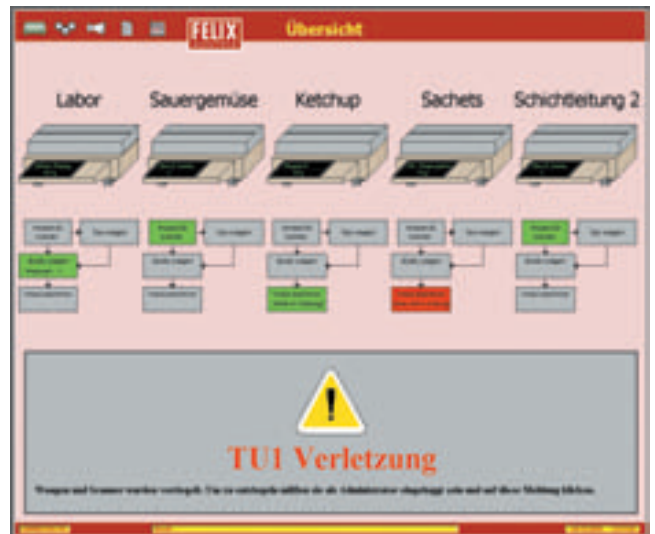
Visualisierung des Prüfprozesses mit »Cimplicity HMI«: Bei der Kontrollstation »Sachets« trat gerade ein Alarm auf.
